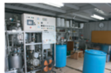
横浜市役所 くるみ会他5施設 無水精製減圧蒸留プラント D-200
